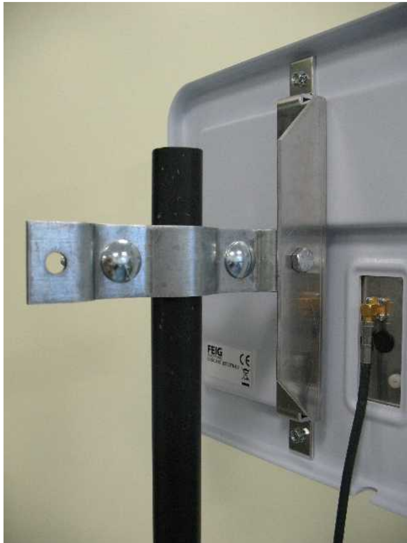
Abbildung 2: Montage der Halterung an der Antenne
