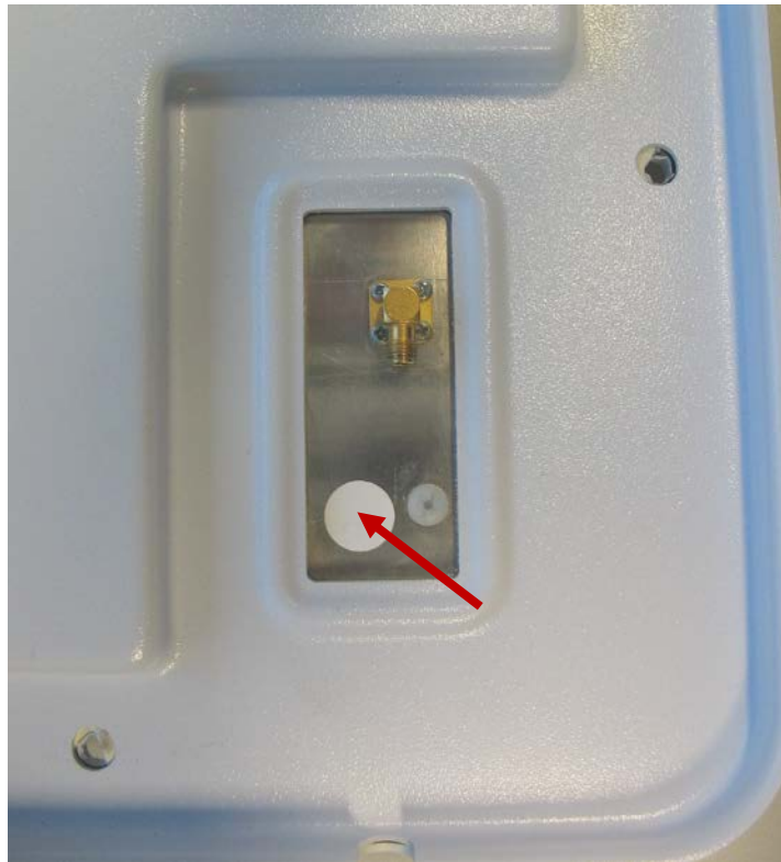
Abbildung 4: Membran zum Druckausgleich
